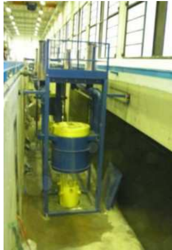
Figura 4.12. Prototipo a escala 1:10 en el canal hidrodinámico. Fuente: PIPO Sistem, SL.
