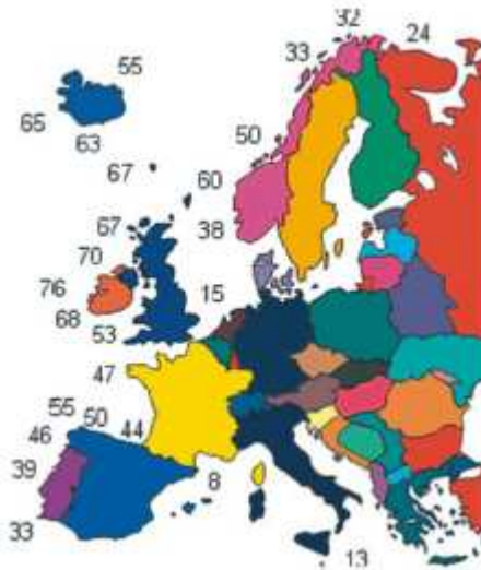
Figura 3.3. Distribución de la potencia del oleaje en aguas europeas. Fuente: CRES, año 2002.
