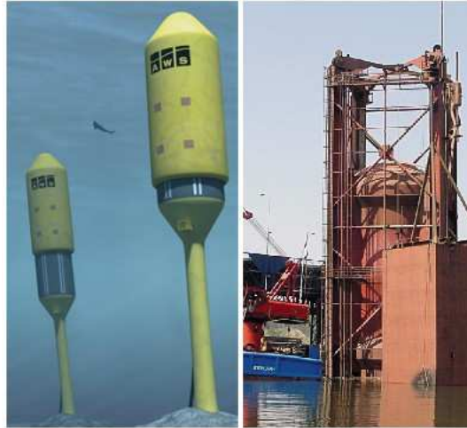
Figura 4.7. Izquierda: Representación del sistema. Derecha: Imagen de una boya. Fuente: www.awsocan.com
