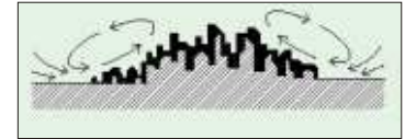
El movimiento del aire en las ciudades es más turbulento que en el campo
