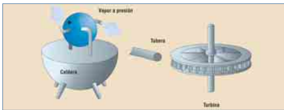
Esquema de producción de vapor para impulsar una turbina.
