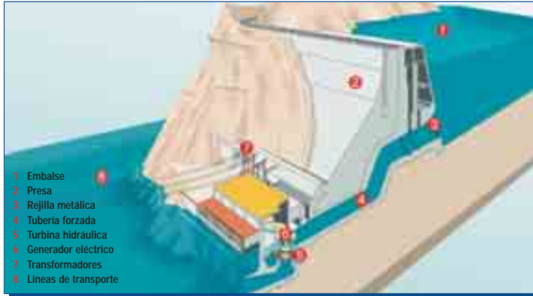
Esquema de central hidroeléctrica.
