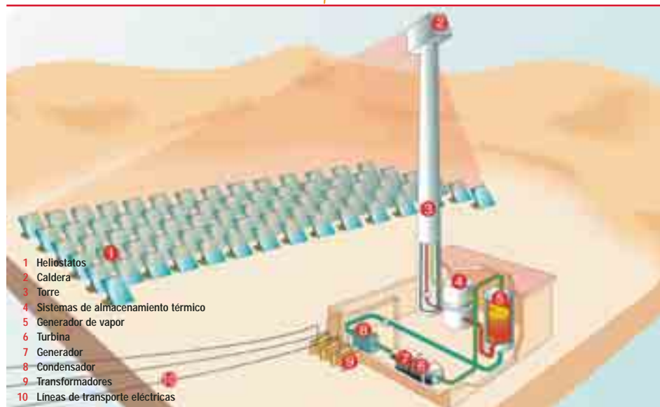
Funcionamiento de una central termosolar tipo torre
