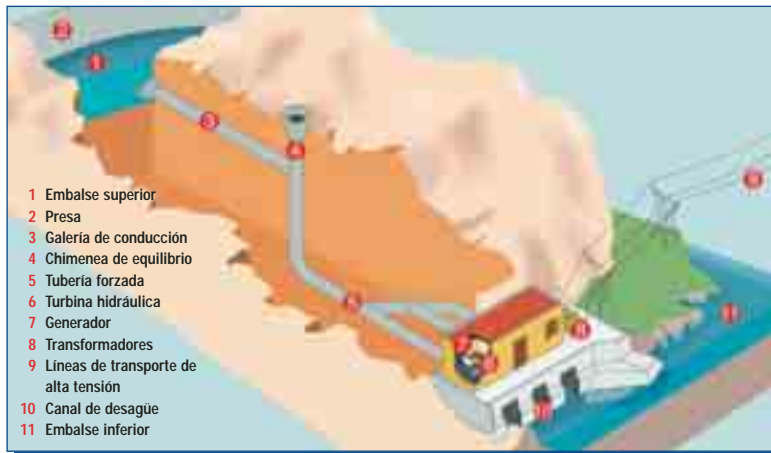
Esquema de central de bombeo.
