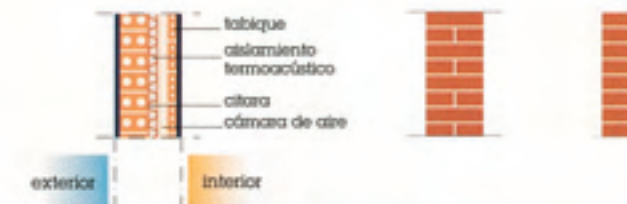
Figura 9. Cerramientos y muros de fábrica de ladrillo
