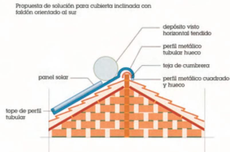
Figura 32. Soluciones Constructiva A
