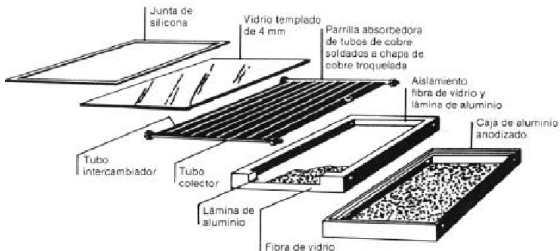
Figura E.9: Elementos del Colector.
