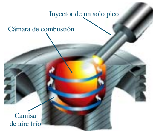
La forma esferoidal de la cámara de combustión del motor elsbetizado y la posición de los inyectores favorece que la mezcla genere una estratificación en espiral de fuera hacia dentro. Así hay menos concentración de aire y no se forman óxidos de nitrógeno.
