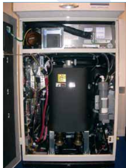
Pila de Combustible modelo GenCore de ARIEMA - Plug Power de 5kW, más barata que un sistema fotovoltaico.
