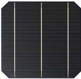
Imagen de una célula monocristalina Fuente: Elaboración propia
