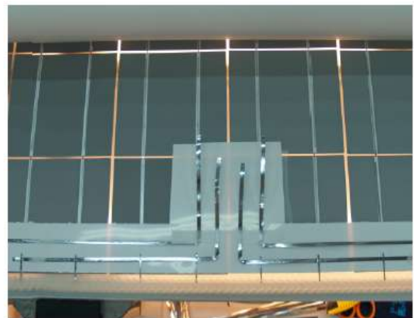
10. Detalle de la interconexión de las células
