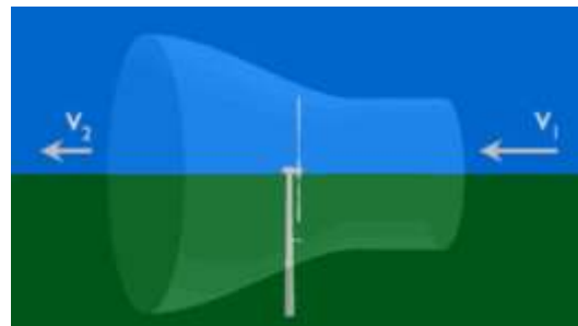
Representación del desvío del viento tras la interacción con una turbina eólica. Fuente: windpower.org
