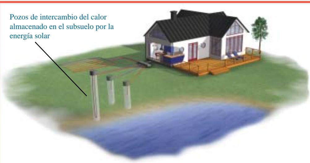
La geotérmica solar es una fuente de energía que permite un rendimiento energético excepcional de 5 kW térmicos por cada kW eléctrico consumido. Imágenes cedidas por GEOTICS.
