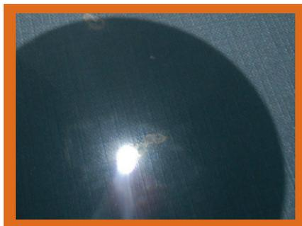
4. Sustituye el papel por el termómetro, enfocando el círculo luminoso sobre su bulbo. Anota la temperatura. No lo dejes mucho tiempo (menos de un minuto) porque corres el riesgo de que el termómetro se rompa.
