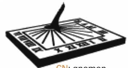
CN: gnomon CF: base de gnomon B: medida del gnomon \alpha : latitud del lugar
